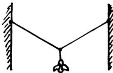
2. Eine Straßenlampe hängt an einem mit  $90^\circ$  eingewinkelten Seil. Die Seilenden ziehen mit der Kraft von 100 Newton an den jeweiligen Hauswänden.
