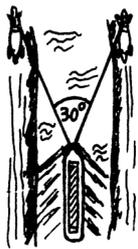
6. Zwei Pferde treideln einen Lastkahn auf einem Kanal. Sie ziehen gleich stark mit je 1 000 Newton. Ihre Zugseile bilden einen Winkel von  $30^\circ$  und sind an einer Öse am Bug des Lastkahns befestigt, dort zieht zugleich der Lastkahn gegen beide Seile.
